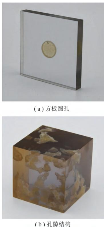
图7 内嵌液体的方板圆孔和孔隙结构的透明3D打印模型
