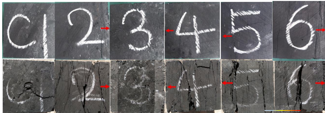
未冲击：层裂式 Non-burst: spallation
